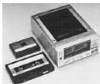
Fig. 14.9. Sony R-DAT prototype (1982) (9)
