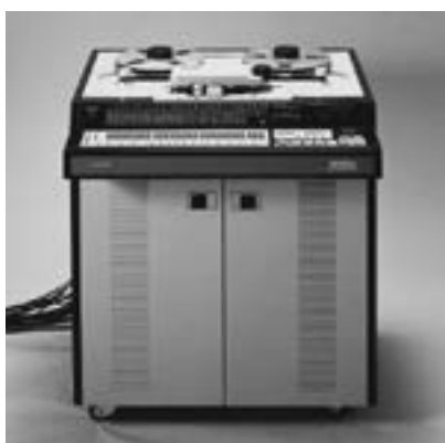
Fig. 14.6. Sony PCM-3324 DASH format 24-channel DAT (5)
