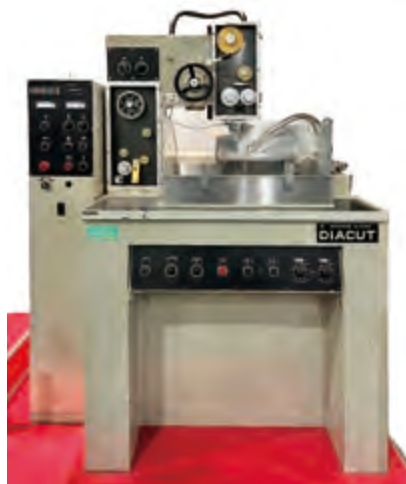
光学式図面倣い装置と接続した状態 (発売当時の製品写真より)
