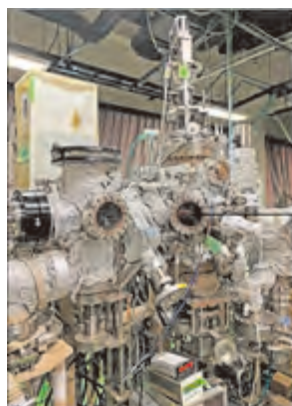
PLD 酸化物薄膜作製装置 [メインチャンバー]
