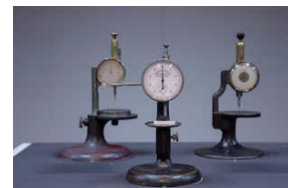
世界初のダイヤルゲージ(1883年 米・ウォルサム社製)
