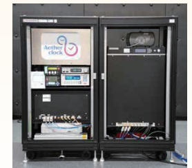
100億年に1秒の誤差の精度を実現した ストロンチウム光格子時計(2025年)
