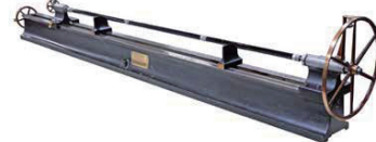
ウィットワース(英)の大型測長器(1850年製)
