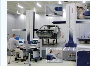
自動車ボディの三次元座標測定の実例
