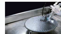
高周波超音波洗浄機 半導体製造におけるウェーハやファブマスクの洗浄 に使用される、独自の石英振動体超音波洗浄機
