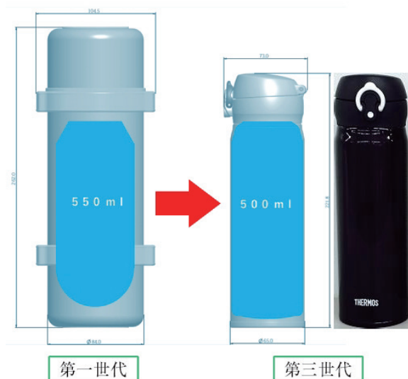
図 7.37 製造工程、加工方法進化による小型化 2)
