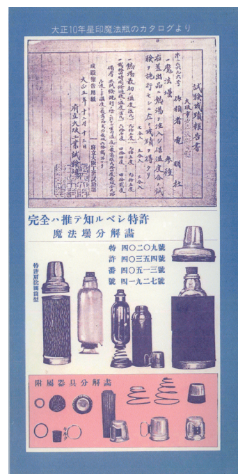
図 2.11 大正 10 年星印魔法瓶の水筒分解図 12)
