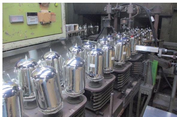
図 4.7 温度検査工程 2)
