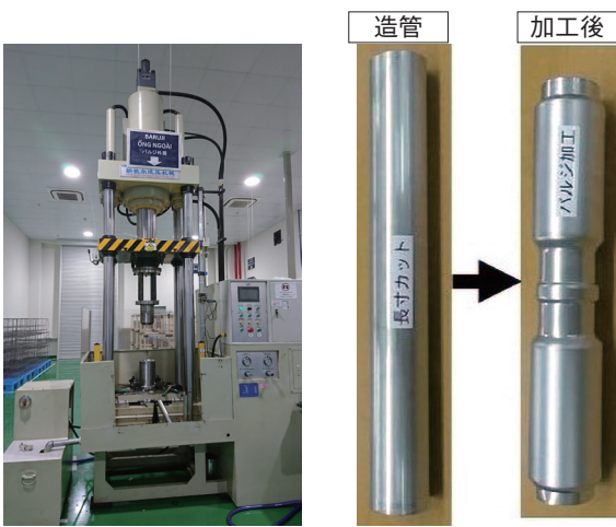
図 6.17 バルジ設備外観 4) 図 6.18 バルジ加工前後品 4)
