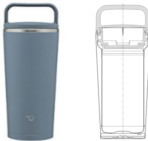
図 7.95 キャリータンブラーの外観と断面構造（象印マホービン SX-J 型） 3)
