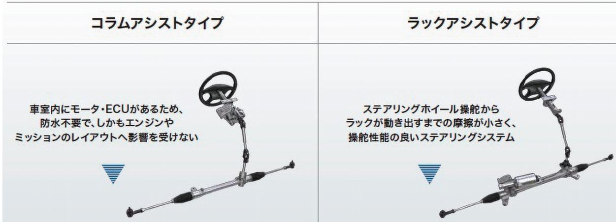
図 2.2.1 ステアリングシステムの分類<sup>1)</sup>
