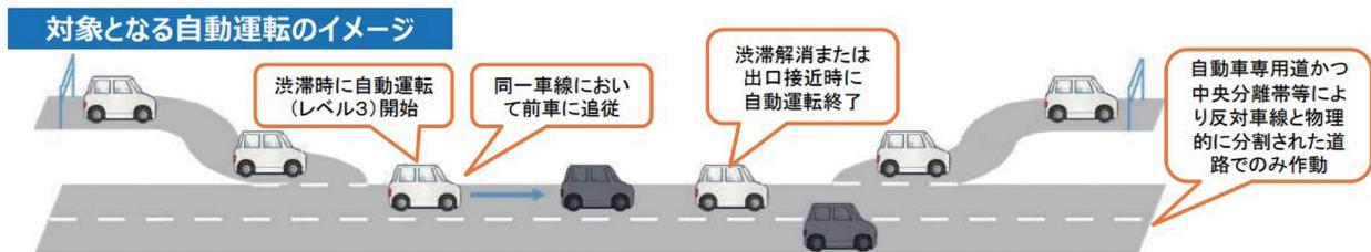
図 7.2.10 自動運転システムの作動概要<sup>4)</sup>
