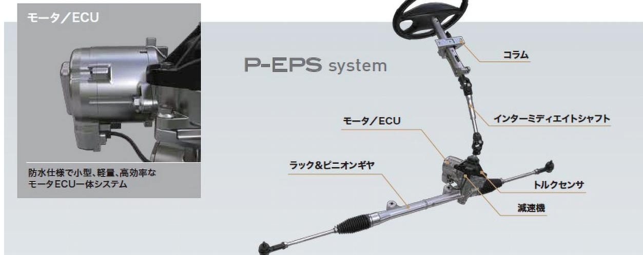
図 2.2.3 ピニオンアシストタイプ (P-EPS) <sup>1)</sup>
