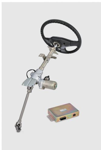
図 3.4.1 世界初の電動パワーステアリング<sup>10)</sup>
