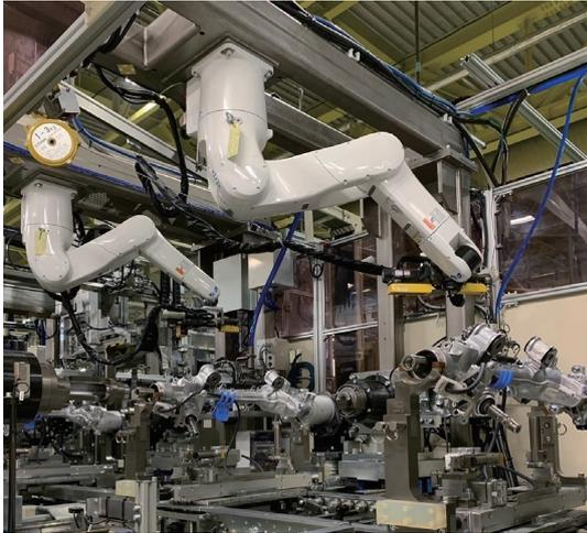
図 6.4.15 RP-EPS ラインの組み立てロボット<sup>12)</sup>
