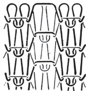
図 4.23 タックを利用した色柄編地 4-24) (太線が色糸A、細線が色糸B)
