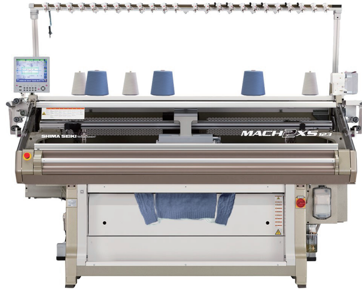
図 7.65 ホールガーメント横編機スプリング式可動式シンカー搭載 (MACH2XS) (島精機製作所提供)
