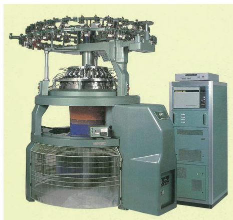
図 4.27 4色オートストライパー付シングルニット電子丸編機 (SEC-24) (福原産業貿易提供)
