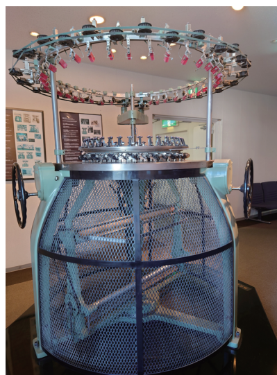
図 4.25 日本初のパターンホイール機構を搭載した大口径丸編機(PFW)(福原産業貿易提供)
