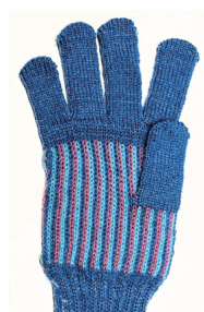
図 5.28 全自動ジャカード手袋編機の製品・親指の編成位置 (島精機製作所ミュージアムで筆者撮影)
