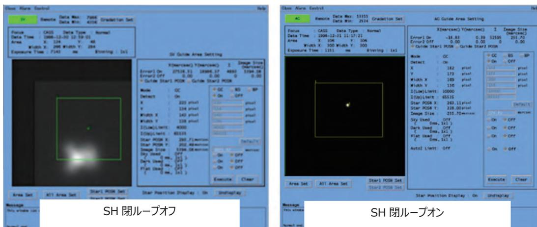
図 5.93 能動光学のSH閉ループの星像改善の様子 (EFL)<sup>5.35)</sup>
