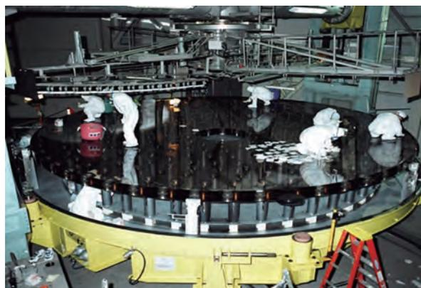
C 部の主鏡洗浄装置の作業
