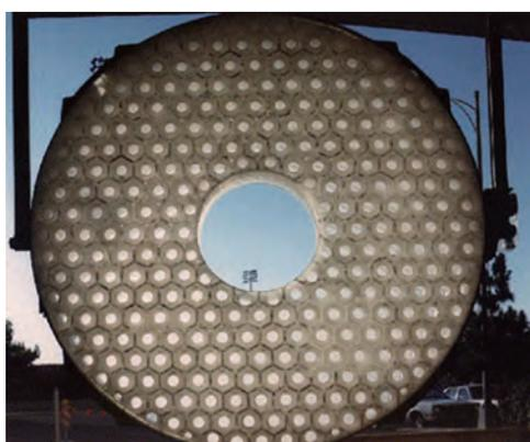
図 5.10 ハネカム構造の 3.5 m 主鏡鏡材
