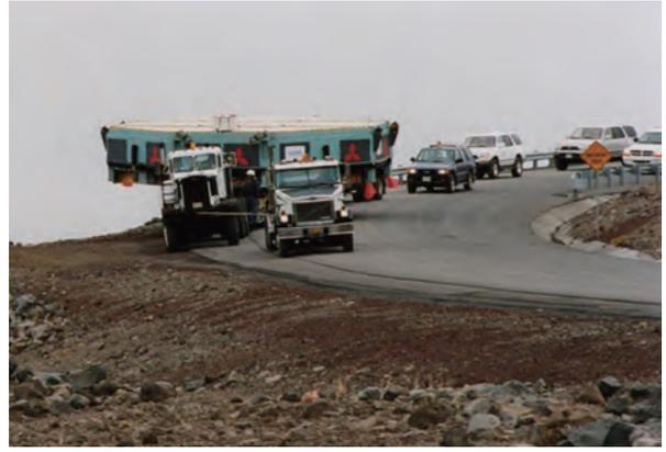
マウナケア山頂に向かう主鏡(手前のトラクタで引張り、トレーラの後ろに隠れているもう1台のトラクタで押して、空気の薄い4000 mの山を登りきる)
