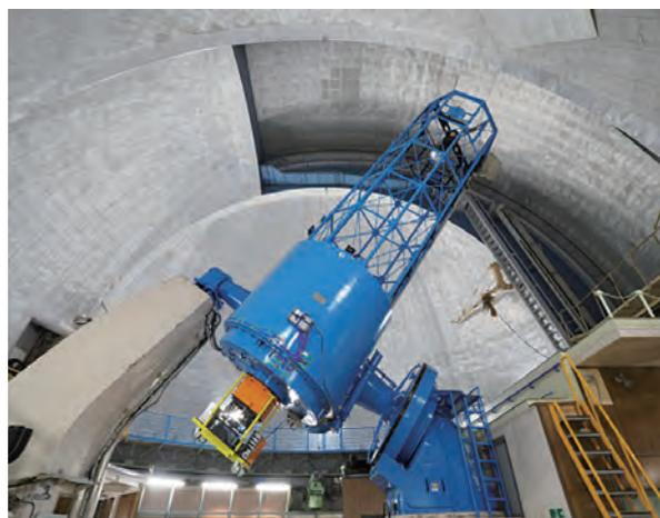
図4.6 1960年英から購入の1.88 m光学望遠鏡(赤道儀)
