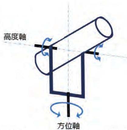
図 2.8 経緯台方式の望遠鏡支持構造のイメージ
