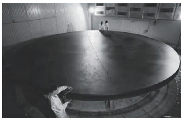
図 5.11 VLT 用の SCHOTT 社 ZERODUR 鏡材
