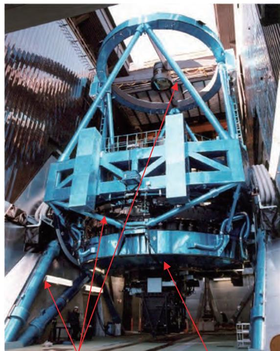
構造がすばるブルーの断熱材で被覆されている。
