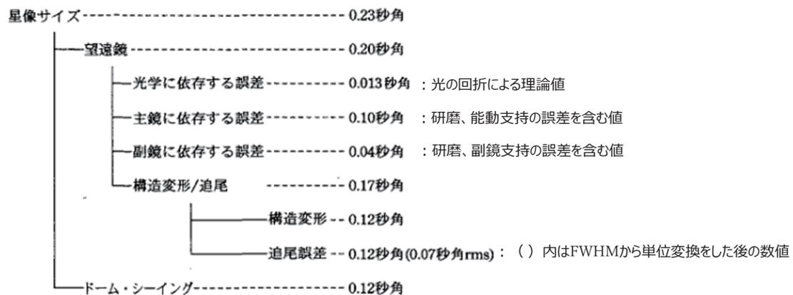
図 5.85 すばる望遠鏡の星像分解能の配分例：カセグレン焦点<sup>5.83)</sup>
