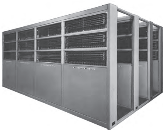
図 8.3 弱電クロスバー盤 3)
