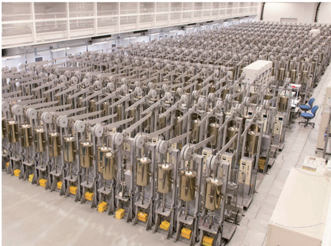
図表 8.04 稼働中のクリープ試験機が整然と並ぶクリープ実験室 (NIMS 提供 28) )
