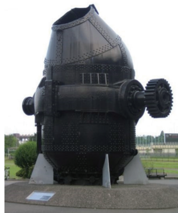
図表 3.05 川崎市民ミュージアム展示のトーマス転炉実機（文献 4 から転載） NKK による寄贈：1937 年導入の実機 5)
