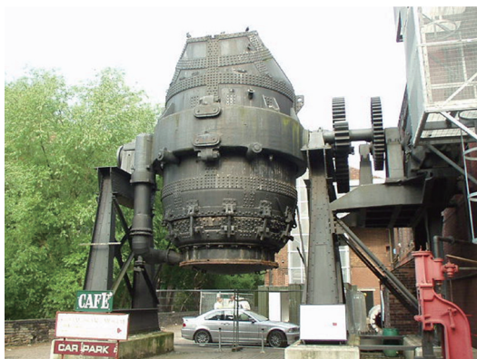
図表 3.04 イギリス、シェフィールド、Kelham Island Museum 展示のベッセマー転炉実機（筆者撮影）
