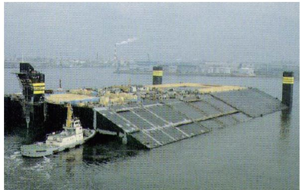
図8.9 SSDC用に建造された潜水型バージMAT<sup>8-1)</sup>:鋼製層を高密度ウレタンで接着させた新しい構造。
