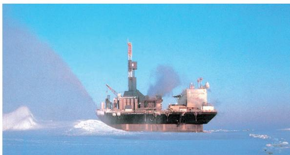
図 8.17 アラスカ、ボーフォート海で稼働中の移動式人工島 Super CIDS <sup>8-8)</sup>
