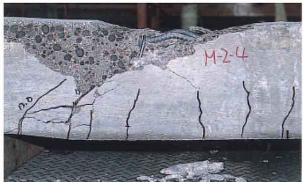
図 6.10 低温コンクリート破壊試験<sup>6-7)</sup>
