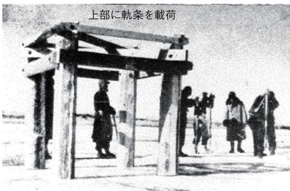
図 4.12 水中杭軌条荷重試験（丸太と氷の凍着強度試験）<sup>4-5)</sup>：氷板の穿孔に 4 脚を挿入する前。4 脚の再結氷させた後に最大 60 ton の軌条を載荷。
