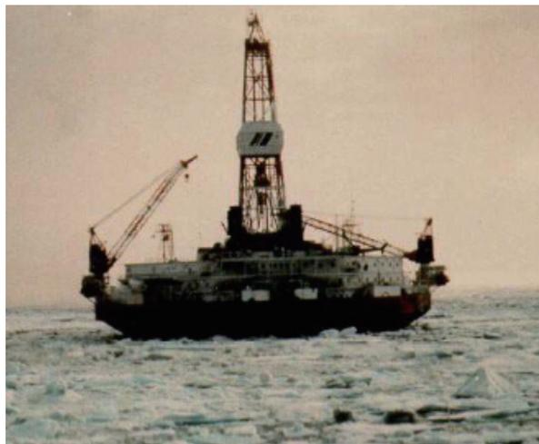
図8.6 逆コーン型の浮体構造のKulluk<sup>8-1)</sup>: 建造は三井造船(株)。
