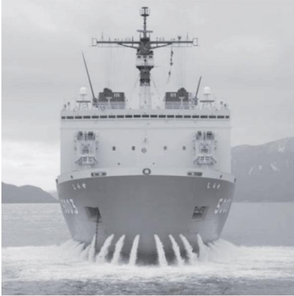
図 9.5 2代目「しらせ」の砕氷補助用散水装置<sup>9-2)</sup>: 船首部水面上にあるノズルから氷板へ散水し、積雪や海水と船体との摩擦抵抗を低減する装置。
