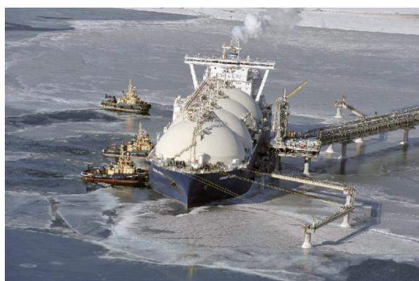
図 3.9 砕氷型 LNG 輸送船と耐氷型港湾施設(サハリン、プリゴロドノエ港)<sup>3-11)</sup>
