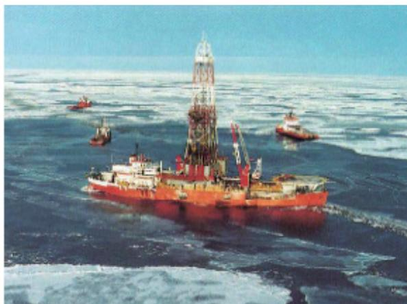
図8.5 浮体式船型ドリルシップ<sup>8-1)</sup>: 氷の影響を軽減するためにサポート船が必要。
