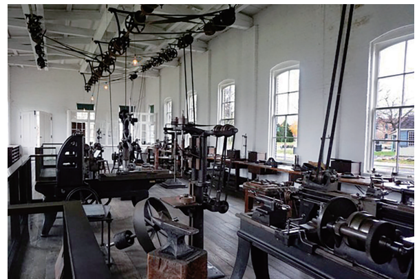
図 3.5 メインシャフトのある工場内風景 5)
