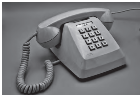
図7-21 601-P電話機「プッシュホン」 底板の塗装を省略したため筐体の裾を深くして底板を隠している。 NTT技術史料館所蔵
