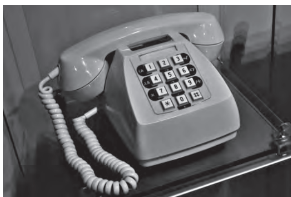
図 6-1 600P電話機「プッシュホン」 計算サービスのためのダイヤルマスクを装着した例。 NTT技術史料館所蔵
