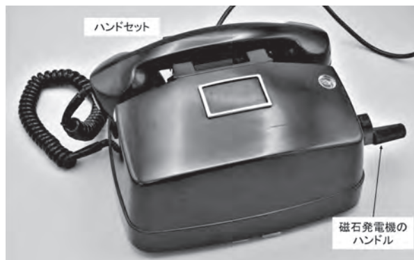
図 2-12 「最後の磁石式電話機」 41号 M電話機 委託公衆電話機用の赤色モデルもあった。 NTT技術史料館所蔵
