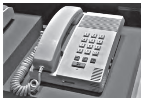
図9-7 (c) 800P電子化電話機「ハウディ」拡声付 S-1P拡声電話機に類似の構成の拡声通話機能をもつ。 NTT技術史料館所蔵
