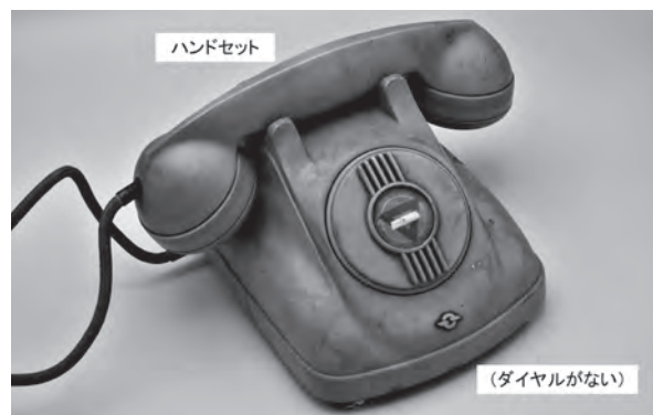
図2-15 4号共電式電話機 自動式電話機のダイヤルを外して蓋をした外觀。 PBX用に遅くまで残った。 NTT技術史料館所蔵
