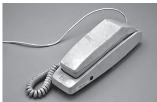
図8-9 (a) 700P電話機「ミニブッシュホン」 H7) 時代を先取りした全電子化電話機。 NTT技術史料館所蔵
