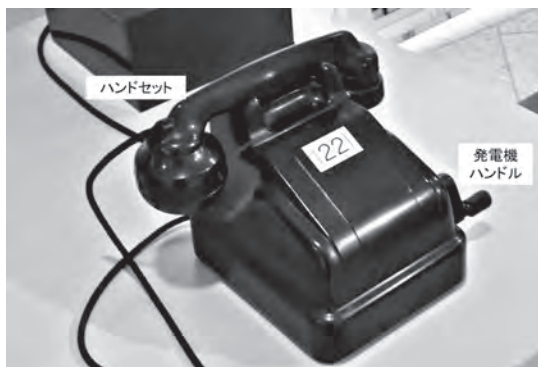
図 2-9 3 号磁石式電話機 プラスチック筐体の卓上型が普及した。 NTT技術史料館所蔵
