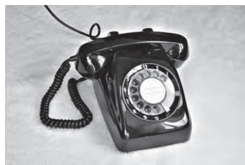
図5-8 600形電話機 1962年に仕様書技術資料が発行されて商用に移行。 1964年より本格導入。
