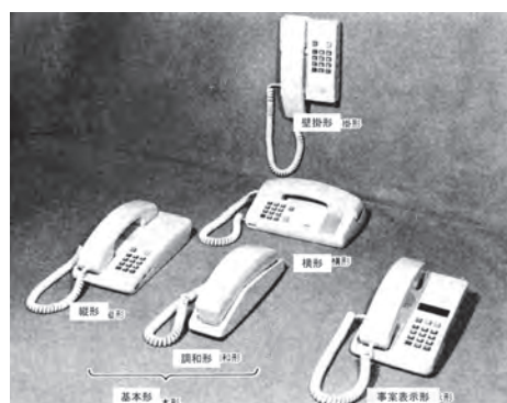
図9-7 (a) 800P電子化電話機「ハウディ」シリーズ 57) 1チップICを用いた全電子化構成なので多様なデザインが可能となった。
