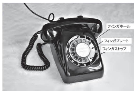
図 2-18 600A電話機の回転ダイヤル フィンガホールに指を入れ、フィンガプレートをフィンガストップまで回して放すとダイヤルパルスが送出される。
