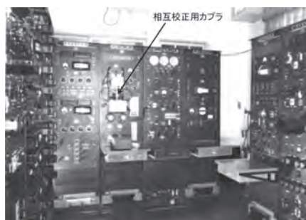
図 3-4 相互校正を行う音響標準装置 (C4) 国家標準又はそのバックアップの役割もあった。
