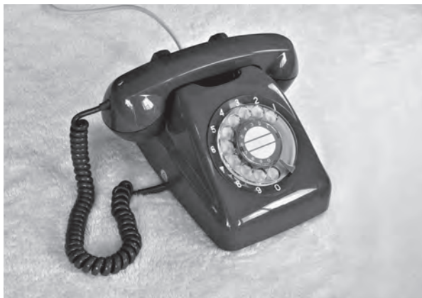
図7-4 601形電話機は600形とは外観イメージをなるべく合わせた明らかに変化したのは重量（軽量化）と磁石電鈴の音色であった。
