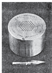
図4-6 (a) VR-601バイプロメータ D4) 動電駆動静電測定。金属部はチタン。直径50 mm。
