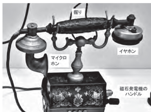
図 2-23 初期のハンドセット 木材と金属を組み合わせた細工物。 てれふおん博物館 (大阪) 所蔵
