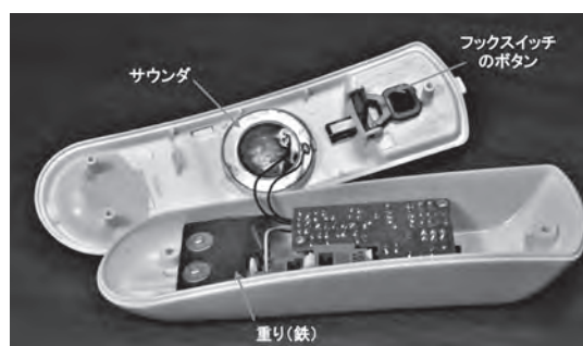
図11-6 (d) ベースセット部 リング用サウンドアは黄銅基板のセラミック圧電ユニモルフ。
