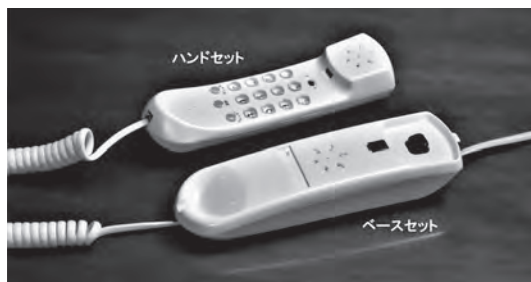
図11-6 (b) 電話基本機能のみの電話機のベースセットとハンドセット キャッチホン、リダイヤル、保留機能、ランプなどを備えている。
