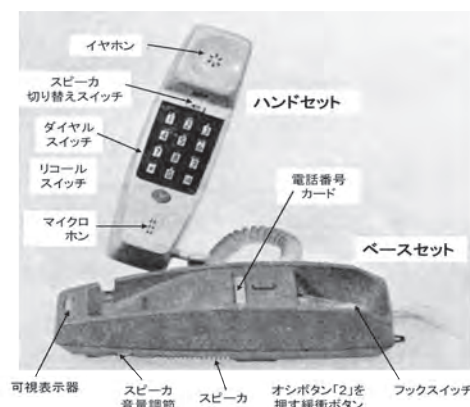
図8-9 (b) 700P電話機の実装構造 17) 主要な電子回路はハンドセット側に搭載されている。
