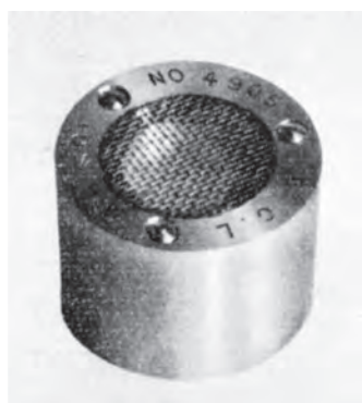
図 3-3(a) MR-101コンデンサマイクロホン (C3) 磁石電鈴の測定に使用。音場測定のため直径32 mmと小型。
