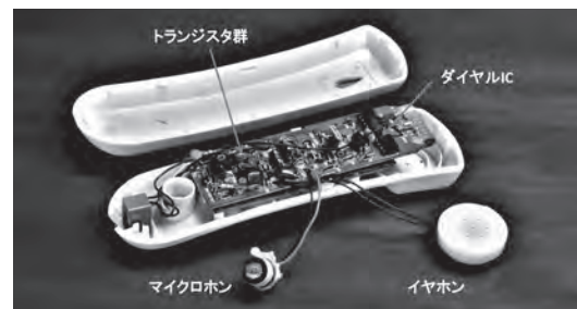
図11-6 (c) ハンドセット部 ダイヤル回路は専用IC、通話回路は複数のトランジスタによる個別回路。回路はチップ部品をあまり用いないゆったりした実装構成。マイクロホンはゴムブッシュに収容してパラフィンで密閉固定。イヤホンは動電形（120 Ω）
