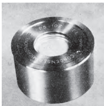
図 3-2(a) PS-102コンデンサマイクロホン (C3) 電話機のマイクロホン、イヤホンの測定に使用。直径80 mm。
