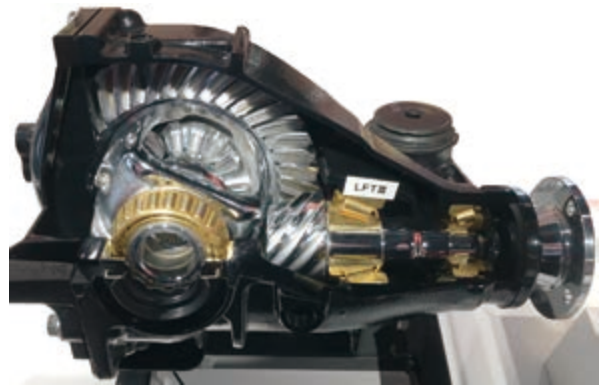
図 4.3.9 低トルク円すいころ軸受を採用した終減速機のカットモデル 47)
