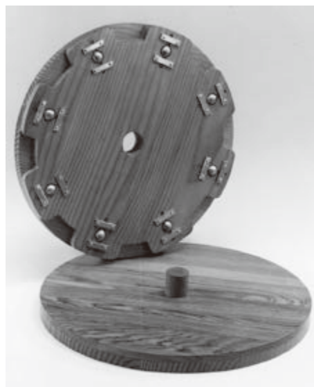
図 3.1.4 ローマ時代の玉軸受の復元品 3)
