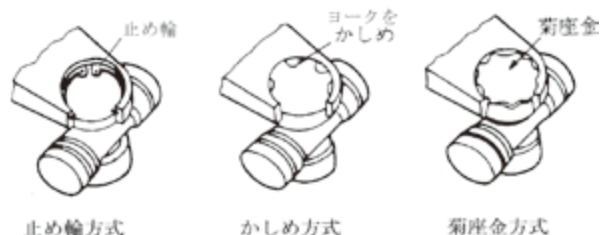
図 4.3.56 十字接手ヨークへのベアリング固定方式 53)
