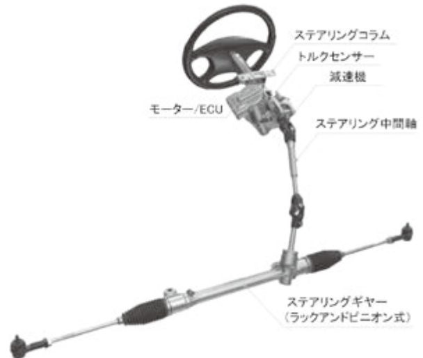
図 4.4.6 電動パワーステアリングの例（コラム式） 70)
