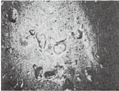
図 4.3.17 開放型玉軸受の異物油中運転後の転動面の状況（圧痕からのクラック） 51)
