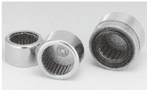
図 4.3.60 推進軸用針状ころ軸受の外観例 (右：ソリッド形、左：シェル形) 25)
