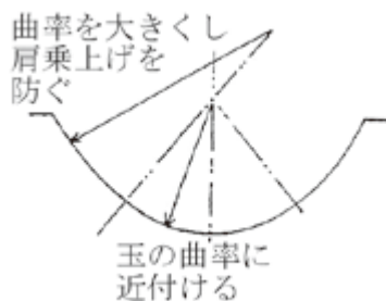
図 4.2.6 半浮動式アクスル用二重曲率深溝玉軸受内輪軌道溝の模式図 30)
