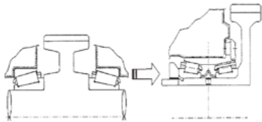
図 4.3.40 FF車用自動変速機出力軸ベアリングの変遷 62)
