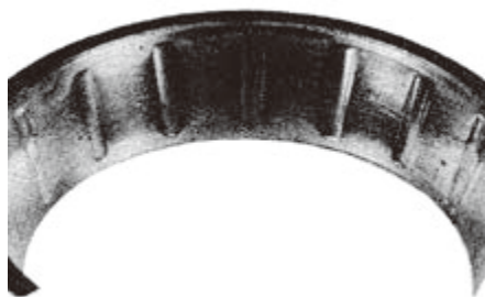
図1 円すいころ軸受の外輪に生じた擬似圧痕の例 1)
