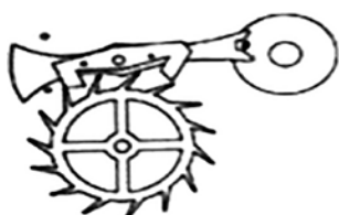
図2.1.6 トーマスマッジ分離式レバー脱進機 1)
