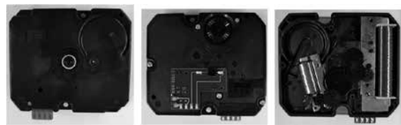
図 3.1.6 ムーブメント外観およびムーブメント内部 7)
