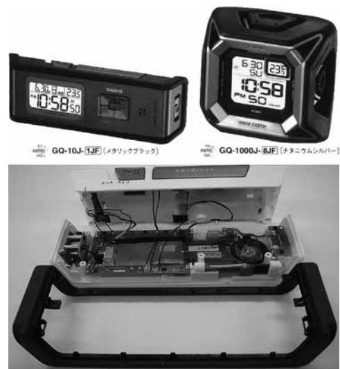
図 4.4.11 耐衝撃電波目覚クロック製品例および内部構成 3)
