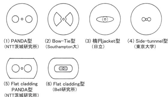
図 5.32 各種の偏波保持ファイバの断面構造
