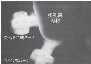
酸水素バーナ炎中でSiCl<sub>4</sub>等を加水分解しガラス微粒子を生成
