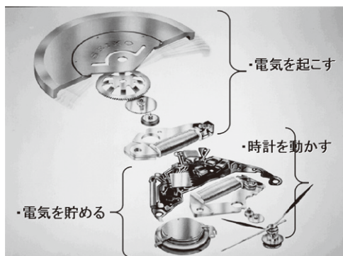
図 7.19 KINETIC のシステム
