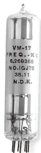
図 5.6 QC-951 の水晶発振器
