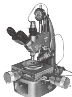
図 6.52 ユニオン 工場顕微鏡 SM 15)
