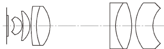
図 7.4 ツァイス・プランアポクロマート 40 \times /0.65 (引用 3 を参考に作成)
