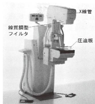
図 10.20 乳房用 X 線撮影装置
