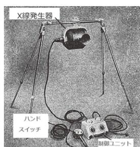
図 10.25 携帯用 X 線装置外観
