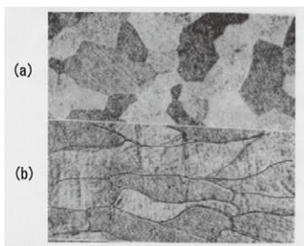
図 8.29 タングステンの焼鈍と鍛造の断面図<sup>18)</sup>
