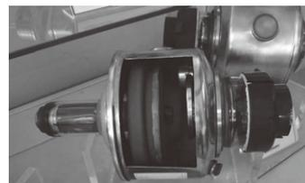
図 9.19 日立センチメートル 2MHU X線管ターゲット外観
