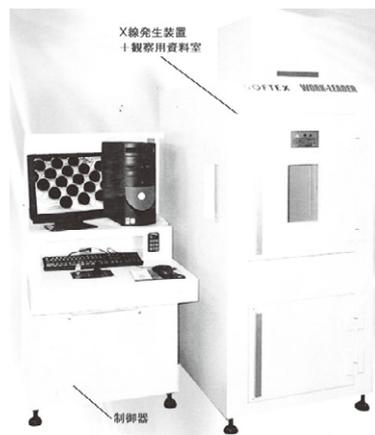
図 10.63 I.I または FPD 搭載<sup>47)</sup> の X 線 TV 検査装置 (ソフテックス)
