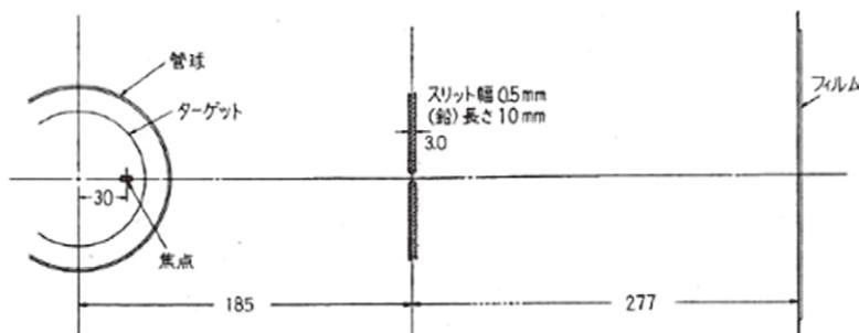
図 8.4 焦点外 X 線強度測定配置図
