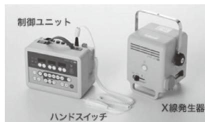
図 10.27 携帯用 X 線装置外観<sup>20)</sup>
