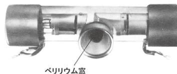
図 10.59 ベリリウム窓軟 X 線管<sup>47)</sup>
