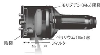
図 10.21 マンモグラフィ用 X 線管の断面<sup>9)</sup>
