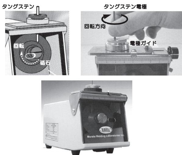
図 3.55 タングステン電極研磨機の一例
