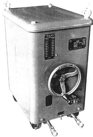
図 4.12 空冷式可動鉄心形交流アーク溶接電源<sup>1)</sup>
