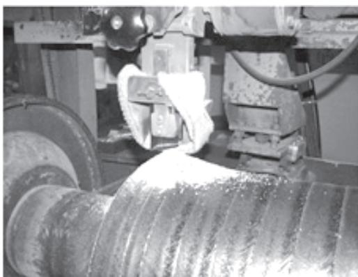
図 3.48 圧延ローラの肉盛溶接<sup>18)</sup>
