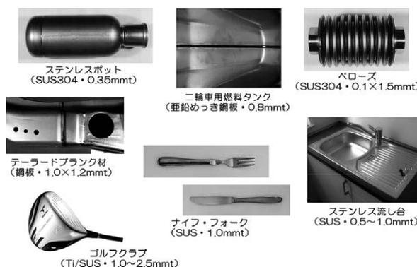
図 3.162 プラズマ溶接の適用例
