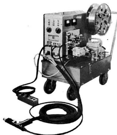
図 3.103 半自動炭酸ガス溶接機<sup>5)</sup>
