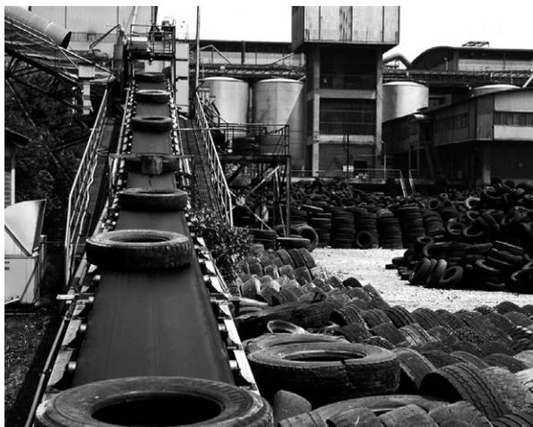
図9.3 セメントキルンへの丸タイヤ搬送装置<sup>3)</sup>
