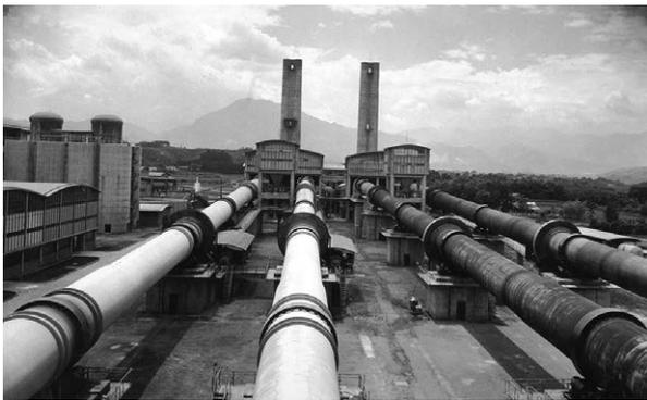
図 4.5 湿式ロングキルン写真(キルン長さ 170m)<sup>7)</sup>
