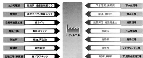
図9.1 セメント工場を中心とした資源循環システム<sup>3)</sup>
