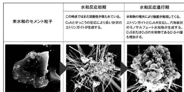
図7.6 ポルトランドセメント水和物の生成過程<sup>1)</sup>
