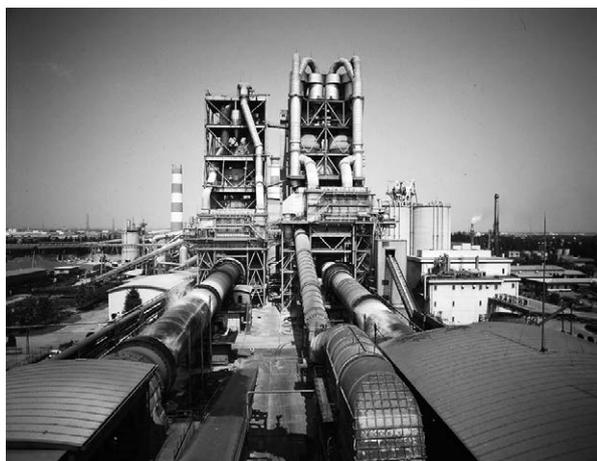
図 1.4 プレヒータータワーと回転窯<sup>2)</sup>
