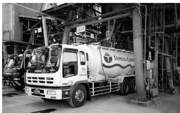
図 4.23 バラトラックへのセメント積込み<sup>7)</sup>
