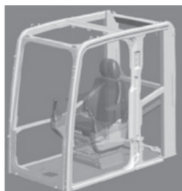
①ROPS対応キャブの骨組み (出典:コマツPC200-10)
