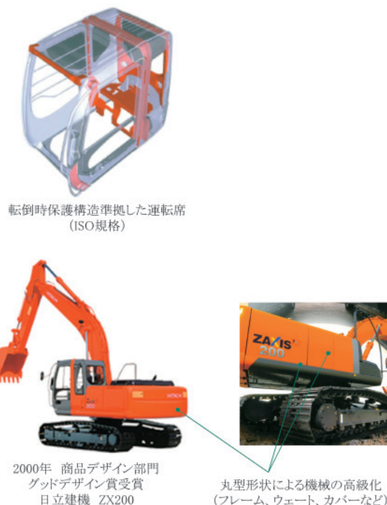
図 3.14 転倒時保護構造運転席と機械の高級化(出典: 日立建機)
