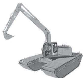
④泥上掘削機
