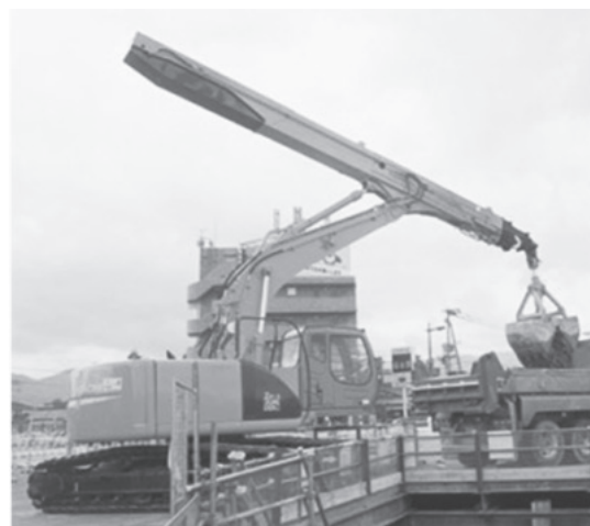
図 2.6 テレスコクラム仕様機 (日立 ZX225USRLC-3) (出典：日立建機 HP)
