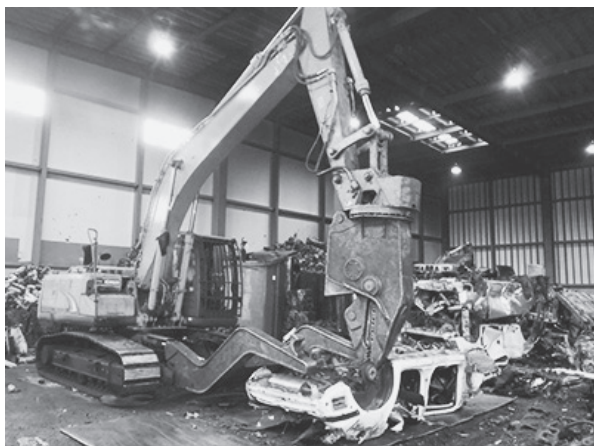
図 2.7 自動車解体機（コベルコ SK210D-8） （出典：コベルコ建機 HP）
