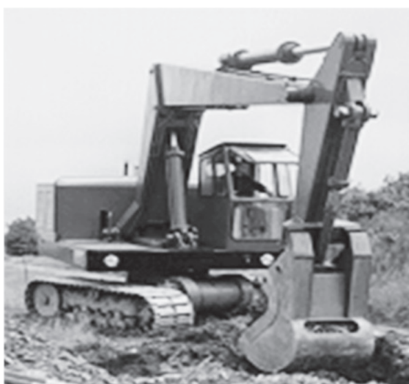
図 3.8 Demag 油圧ショベル B-504
