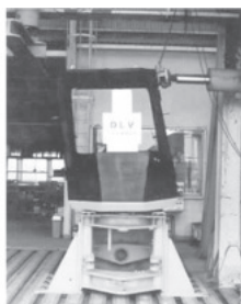
②ROPS基準による強度試験 (出典:施工技術総合研究所)
