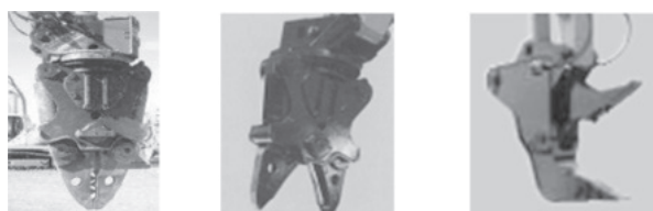
①コンクリート用 ②鉄筋鉄骨用 ③道路用 図 5.4 解体用各種アタッチメント（開発当初品） （写真出典：日立建機）
