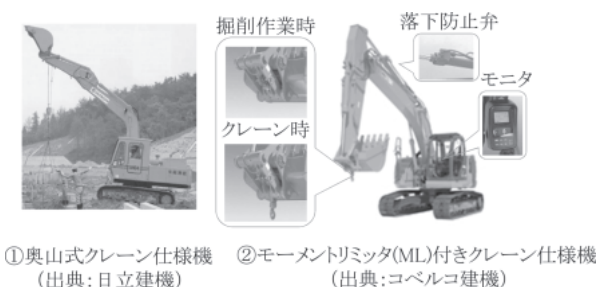
図 5.10 油圧ショベルのクレーン仕様機
