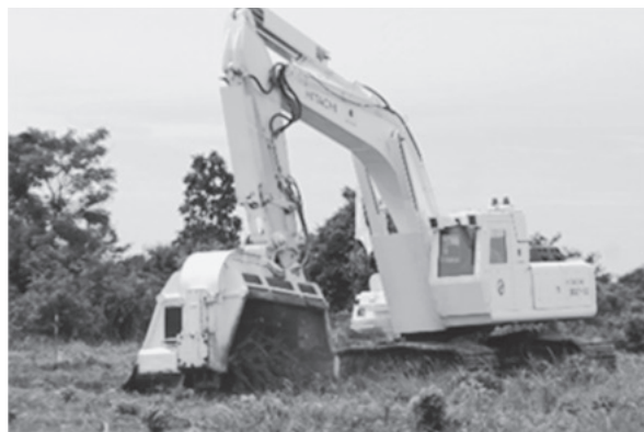
図 2.10 地雷処理機（日建 BM307） （出典：日立建機）
