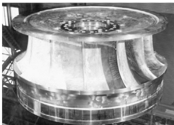
図 7.26 水力発電用フランシスランナー 29) (日本製鋼所) 13Cr-3.8Ni 鋳鋼、重量 140 トン
