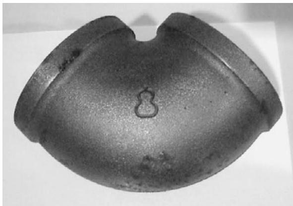
図7.15 ひょうたん印の可鍛鑄鉄製継手 (日立金属鑄物記念館)
