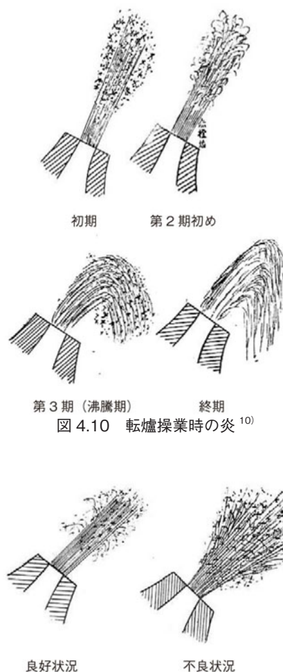
図 4.11 轉爐操業時の炎による爐況 10)
