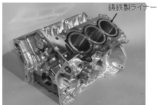
図 7.19 アルミニウムダイカスト製シリンダーブロックと鋳鉄製ライナー 23)
