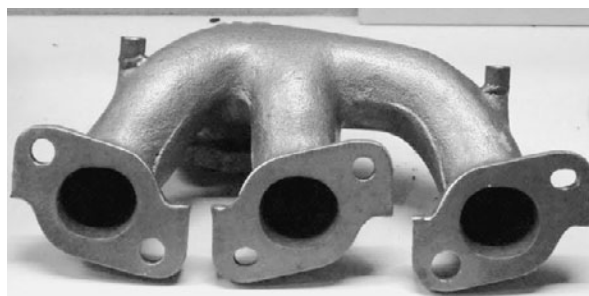
図 7.28 耐熱鋳鋼製エキゾーストマニホールド (日立金属)
