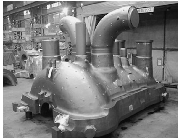
図 7.31 車室下半分 Cr-Mo-V 鋳鋼 23) (日本製鋼所) 重量 47 トン
