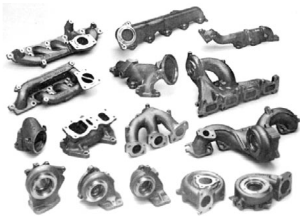
図 2.13 自動車部品として鋳鉄鋳物
