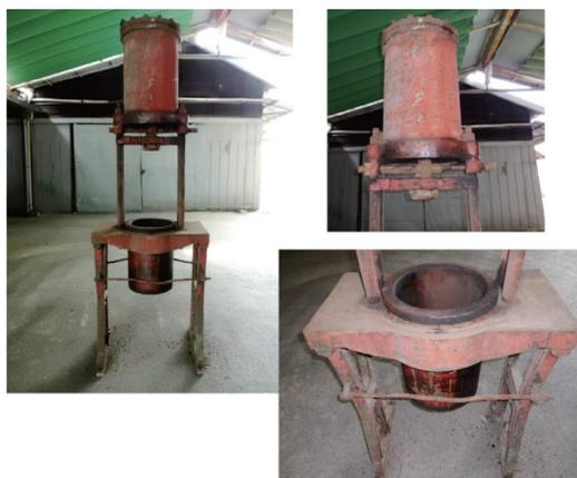
図 3.17 蚊取り線香の押し出し機（大日本除虫菊（株）提供）
