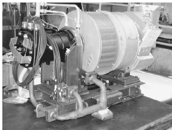
図 9.22 TCS、過給機と発電機の結合写真（三井造船提供）
