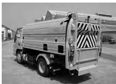
図 4.122 ロータリ式じん芥車（1964 年に開発され現在もほぼ同様構造で生産） (25)
