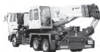
図 4.183 トラッククレーン (3)
