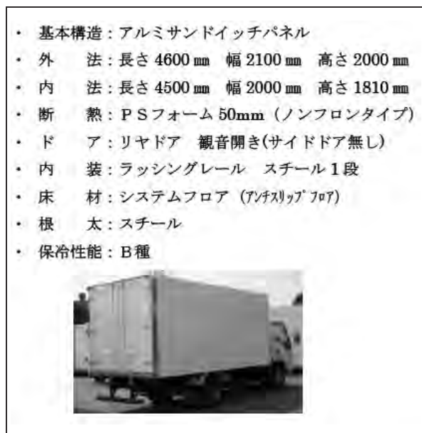
図 3.100 試作、解体実験を行ったコンテナ
