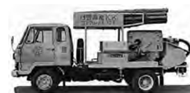
図 3.35 コンクリートポンプ車 (31)
