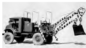
図 4.2 掘削積み込み車 (2)
