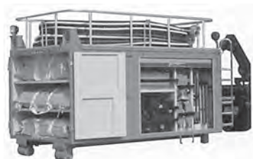
図 4.165 消防機材運搬コンテナ (ホースや空気ポンプ等の機材運搬用 出動態勢 に応じた積載物を搭載したコンテナを使用) (2)
