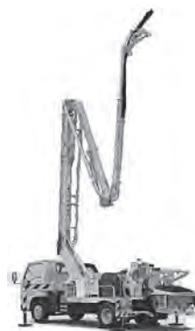
図 4.173 コンクリートポンプ車 (13)
