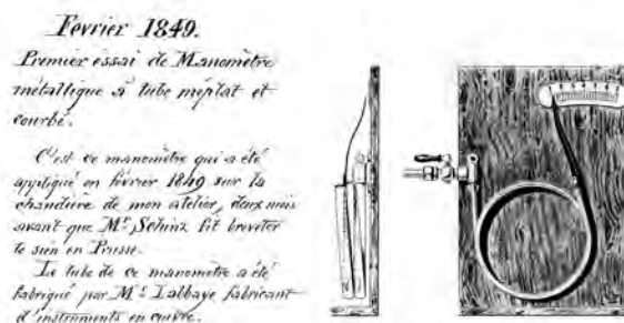
図 4.1 ブルドン管の変位を直接読み取る圧力計 (1849) ブルドン社提供
