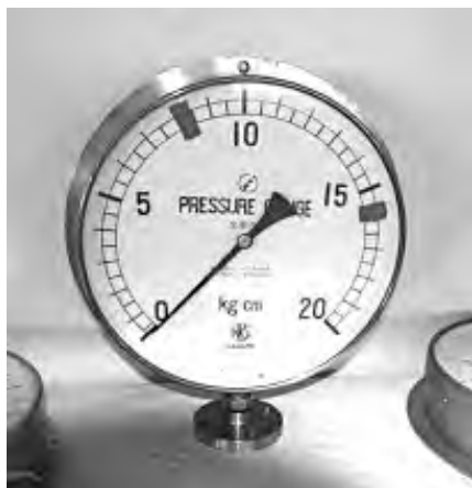
図 4.45 1940 年代の同心丸形圧力計（JIS 形） 板金成形、銀口ウ付け、枠の大きさ 200 φ 黄銅板の枠 長野計器（株）提供
