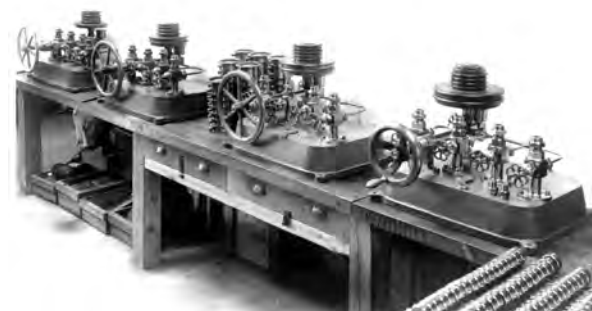
図 3.13 重錘形圧力計 100Kg/cm 2 4 連卓上用 1941 年頃（株）右下計器製作所提供
