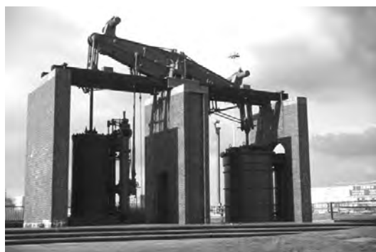
図 2.7 1817 年のワットの蒸気機関（英バーミンガム） ©Chris Allen
