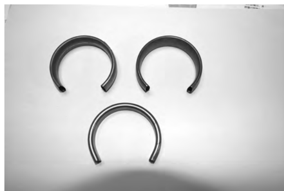
図 4.25 100 φ C形ブルドン管（株）荏原計器製作所提供 2008 年
