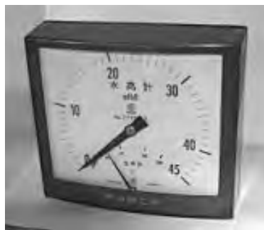
図 4.48 200 角形圧力計（赤色樹脂成形） 1980 年代 長野計器（株）提供
