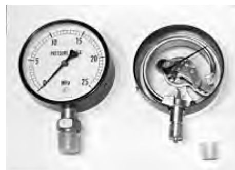
図 4.44 現在の同心丸形圧力計（JIS形）プレス成形枠の大きさ100φ 長野計器（株）提供
