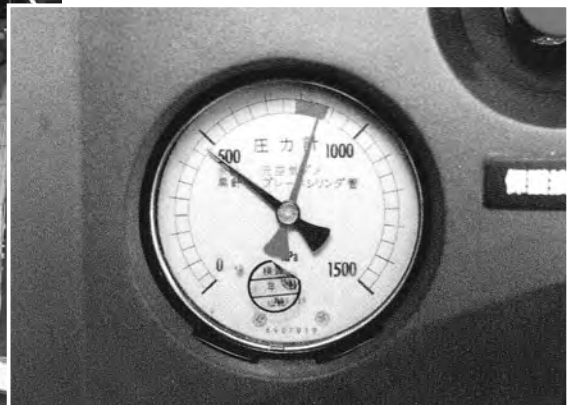
図 1.6 長野新幹線「あさま」に搭載の圧力計 長野計器（株） 2008（平成 20）年提供
