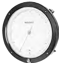
図 5.9 300 φ 精密圧力計 1958 年 長野計器（株）提供
