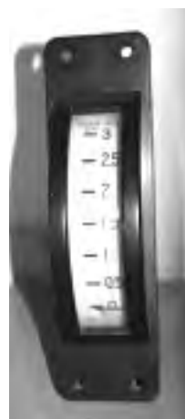
図 4.39 エッジワイズ 縦形圧力計 1970 年代 長野計器 (株) 提供
