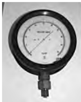
図 4.49 200 φ精密圧力計 アルミ DC ミラー付 1980 年代 長野計器（株）提供
