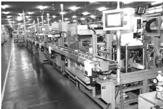
図 4.53 小形圧力計自動組立ライン 2005 年 長野計器（株）提供
