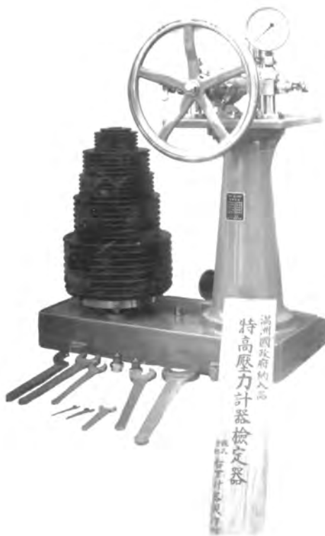
図 5.5 満州国政府納入品 特高圧力計器検定器 1500Kg/cm 2 1941年 商工省中央度量衡検定所 (株) 右下精器製造提供
