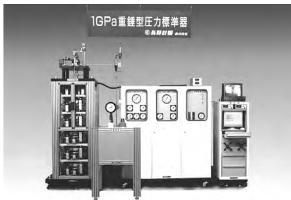
図 5.4 1GPa 重錘形圧力標準器 2000年 長野計器（株）提供
