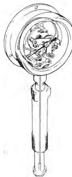
図 5.15 高温用ダイヤフラムシール式圧力計 (15) 1971 年
