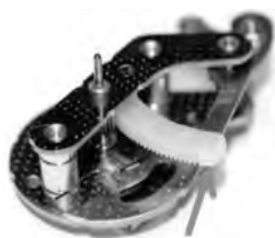
図 4.35 モールドセクタステンレス鋼 100 φ用 1970 年代 長野計器 (株) 提供
