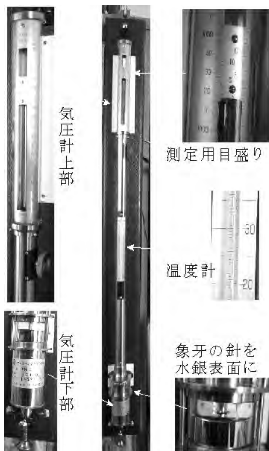
図 5.2 フォルタン形気圧計（中央）左右は部分拡大したもの (5)
