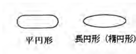
図 4.16 ブルドン管の断面 (23)
