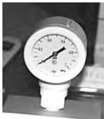
図 4.51 全樹脂 60 φ 圧力計 1980 年代 長野計器（株）提供
