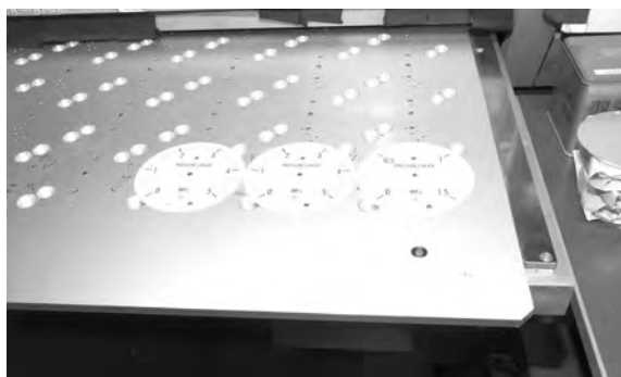
図 4.56 一般圧力計文字書自動化設備 2005 年 長野計器（株）提供
