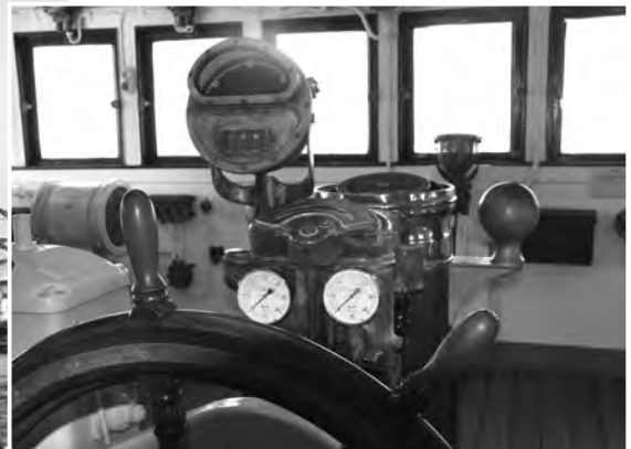
図 1.5 氷川丸に搭載の圧力計 日本郵船 1930（昭和 5）年竣工 氷川丸（横浜市山下公園地）提供
