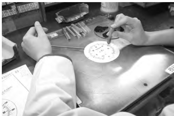
図 4.55 目盛半印刷（ゴム印）1980 年代 長野計器（株）提供
