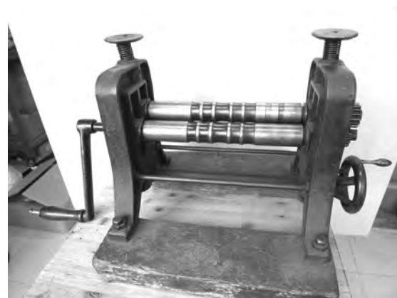
図 4.17 ローラー成形機（株）荏原計器製作所提供
