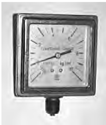
図 4.47 100 角形圧力計アルミ DC（銀色） 1970 年代 長野計器（株）提供
