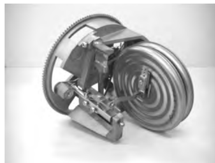
図 3.18 航空機用（高度計）チャンバ 東京航空計器（株）提供
