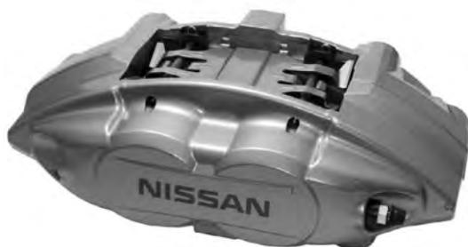
図 6.37 最新のオポーズド型ディスクブレーキ曙ブレーキ「ブレーキ博物館」所蔵サンプル（筆者撮影）
