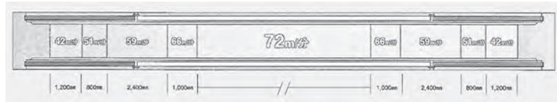
図 7.7 フジテックの可変速式動く歩道
