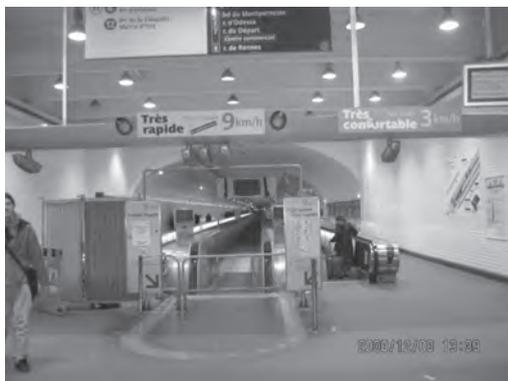
図 7.8 CNIM 社の可変速式動く歩道 中間高速部 9 km / 時
