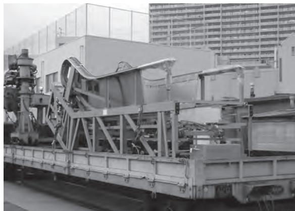
図 5.31 鉄道工事用作業車（トロック）で搬出入作業（2003年）三菱電機ビルテクノサービス提供
