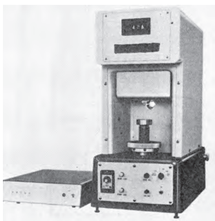
図5.8-3 基準ロックウェル硬さ試験機 *1)
