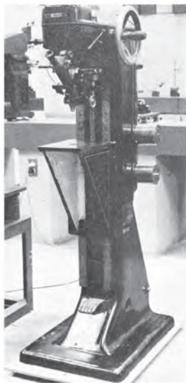
図5.4-2 ビッカース硬さ試験機*1) [イギリス Vickers-Armstrong 社製]
