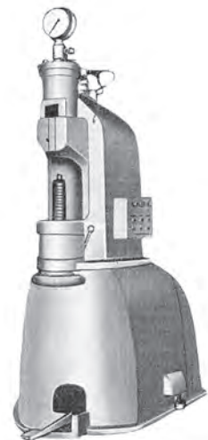
図5.1-5 高速ブリネル硬さ試験機 〔(株)東京衡機製造所〕 3)
