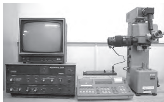
図5.4-11 ビッカース自動硬さ試験機 (Autovick) [(株)明石製作所] *1, 26, 28)
