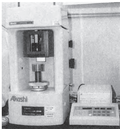
図5.8-8 ロックウェル硬さ標準機 68)
