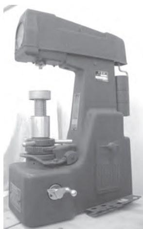
図5.3-3 1段てこ式ロックウェル硬さ試験機[アメリカ Wilson社製]* 1)
