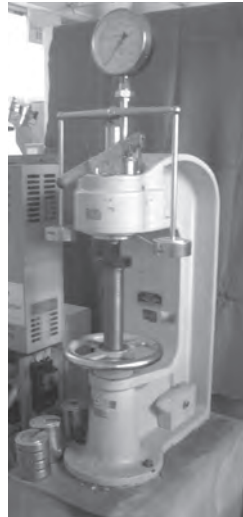
〔(株)島津製作所〕 〔(株)富士試験機製作所〕 図5.1-3 油圧式ブリネル硬さ試験機(オルゼン型)
