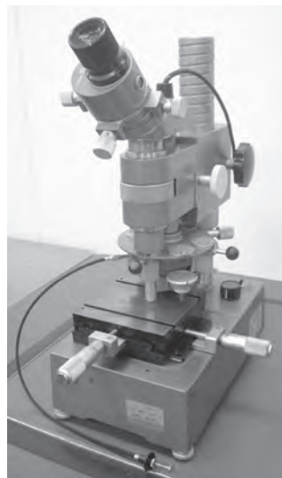
図5.4-5 デュリメット微小荷重 硬度計[ドイツ Leitz社製] 20)
