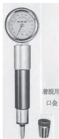
図5.6-4 ポータブルショア硬度計 PD-1型[(株)仲井精機] 43)
