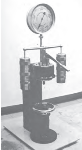
図5.1-2 油圧式ブリネル硬さ試験機 〔アメリカ Olsen社製〕 *1)
