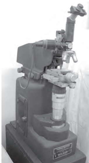
図5.4-4 ツーコン(Tukon)試験機 [アメリカ Wilson社製] *1)
