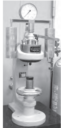
〔(株)島津製作所〕 〔(株)富士試験機製作所〕 図5.1-3 油圧式ブリネル硬さ試験機(オルゼン型)
