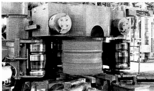
図 6.6 リングロール圧延機
