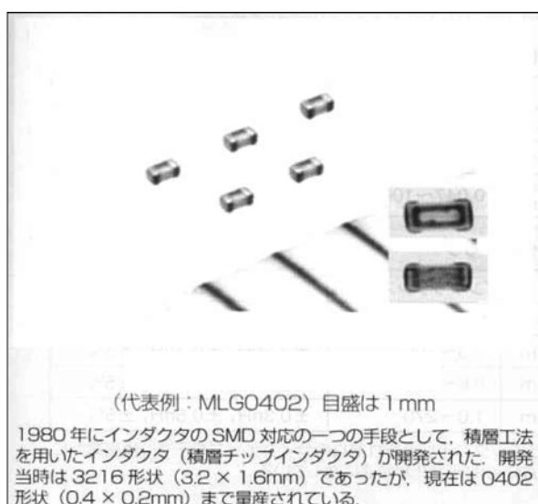
図 7.1 積層チップインダクタ 2)
