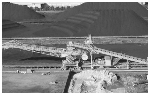
図3.34 最近のスタッカ（石炭用1,350t/h） 三井三池製作所提供
