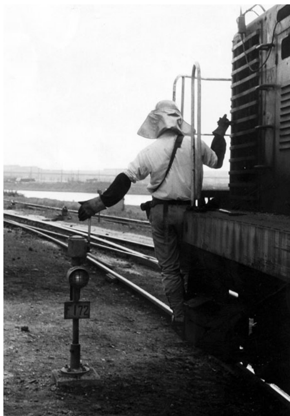
図4.24 転轍機遠隔操作状況 新日本製鉄八幡製鉄提供
