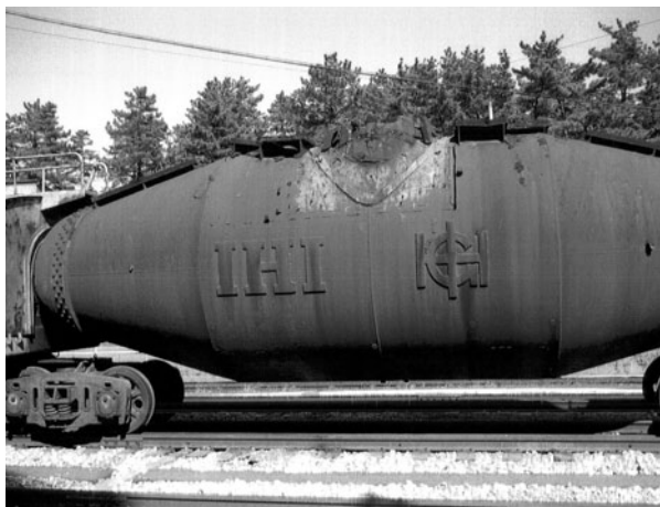
図4.7 住友金属工業和歌山製鉄所130ton混銑車 住友金属工業和歌山製鉄所提供
