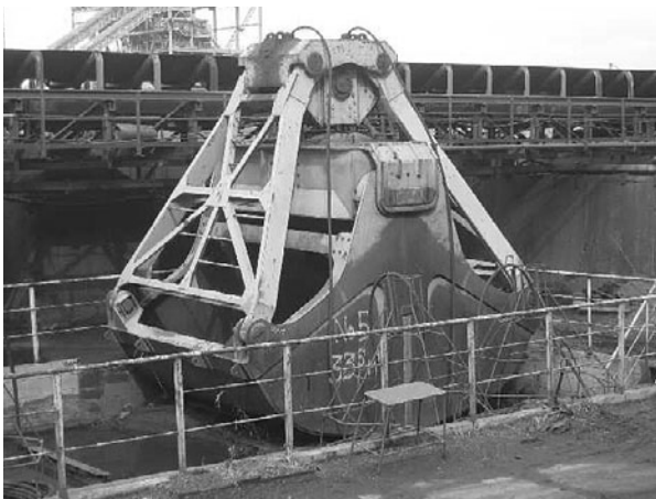
図3.17 石炭用25tonグラブバケット 新日本製鉄八幡製鉄提供
