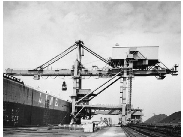
図3.22 名古屋製鉄所 2,800t/hアンローダ 三菱重工業広島製作所蔵
