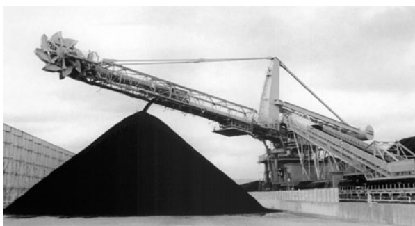
図3.41 最近のスタッカリクレーマ （石炭用 積み付け5,000t/h、払い出し1,000t/h） 三井三池製作所提供
