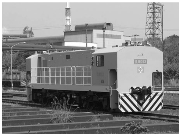
図4.19 君津製鉄所 電気式ディーゼル機関車 新日本製鉄君津製鉄所提供
