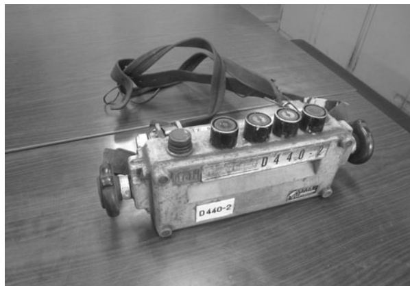
図4.25 機関車操作用リモコン操作盤 新日本製鉄八幡製鉄提供
