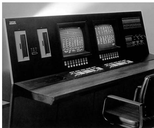
図5.7 初代CENTUMのオペレータステーション
