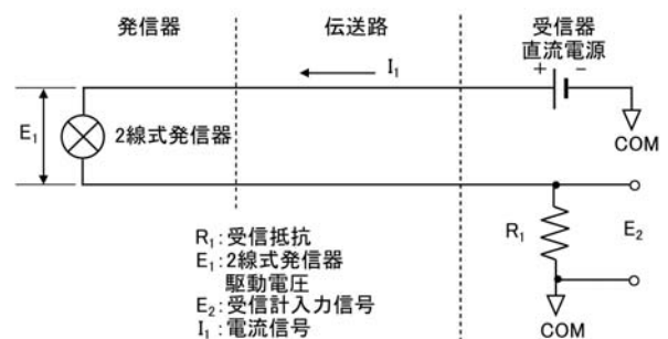
図7.2 2線式発信器の回路例
