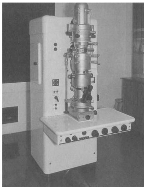
図3.9 シーメンスの電子顕微鏡Elmiskop I<sup>(21)</sup>
