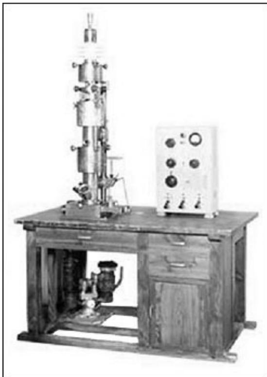
図3.6 日本電子の前身の電子科学が最初に製造した磁場型電子顕微鏡（DA-1型）<sup>(11)</sup>
