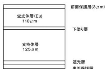
図4.14 イメージングプレートの構造
