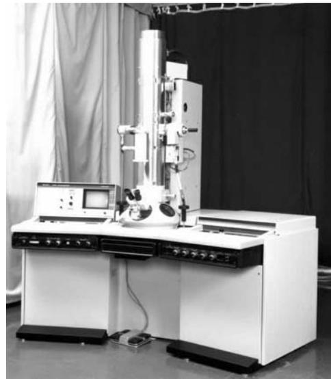
図4.17 国産初のマイコン搭載電子顕微鏡H-600型<sup>(11)</sup>
