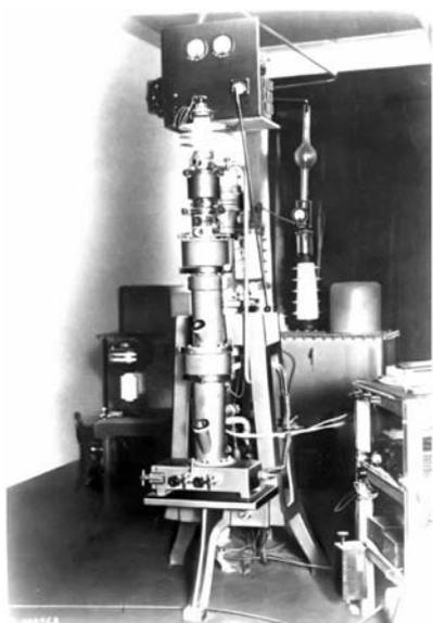
図3.4 最初に実用となった電子顕微鏡<sup>(7)</sup>
