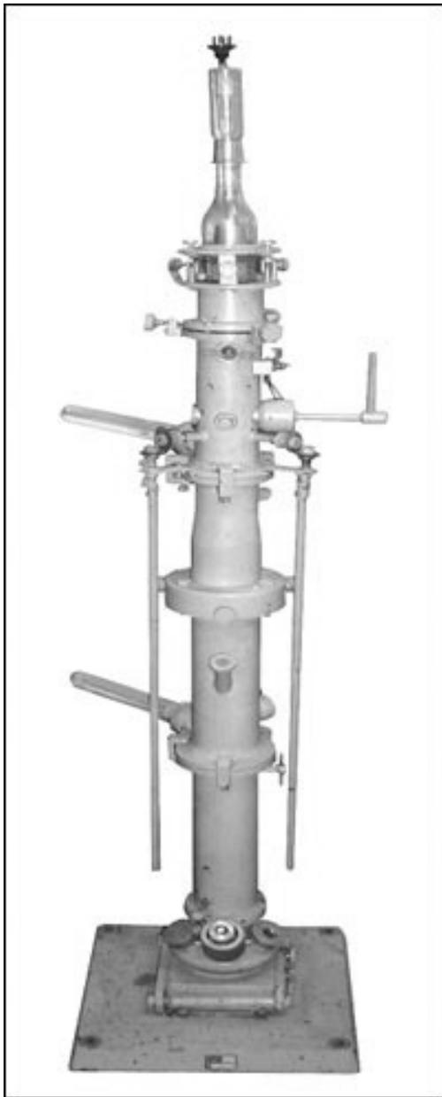
図3.1 東京帝国大学製の電界型電子顕微鏡<sup>(4)</sup>
