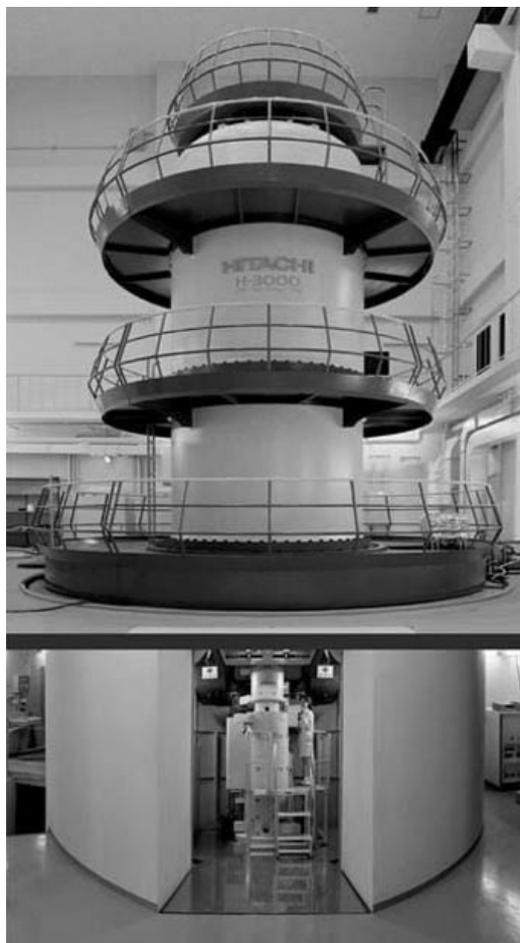
図5.7 阪大に設置されている超高圧電子顕微鏡（日立製作所製）<sup>(8)</sup>
