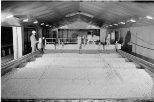
図5.7 通風製麹装置 (TF)<sup>2)</sup>
