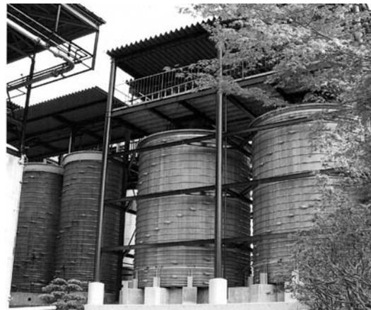
図5.21 屋外式木製大型タンク<sup>51)</sup>
