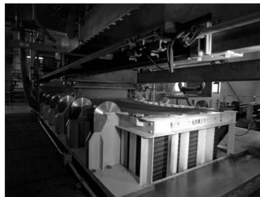
図5.31 大型長尺濾布諸味充填装置<sup>2)</sup>
