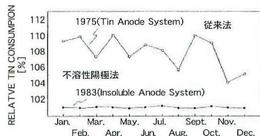
図 7.30 錫原単位の比較 (広畑製鐵所 No.2 ETL)<sup>30</sup>
