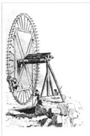
図2.2 人力による歩行形 巻き上げ機
