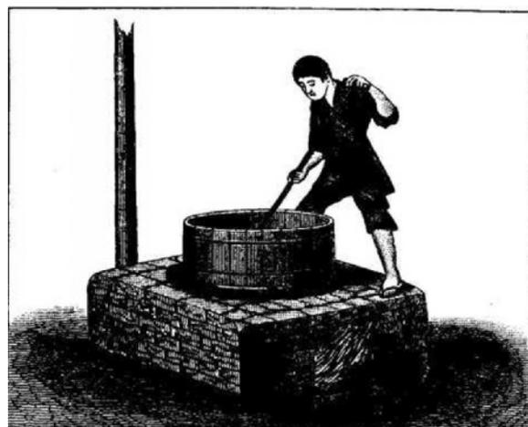
図3.5 鹼化釜と攪拌作業<sup>(28)</sup>
