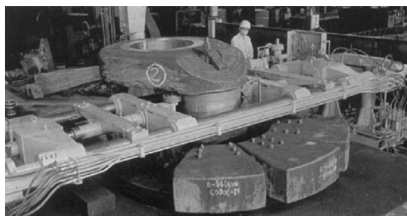
図4.4 初期の冷間ロール加工設備 神戸製鋼提供
