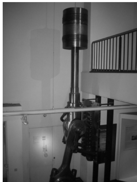
付図-4 クロスヘッド複動機関の1シリンダ分 Deutsches Museum所蔵
