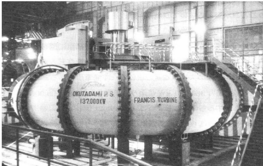
図6.2 フランジ接続のケーシングの例
