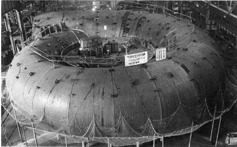
図9.2 グリII発電所用 730,000kWフランシス水車ケーシング 工場仮組立（写真提供：日立製作所）
