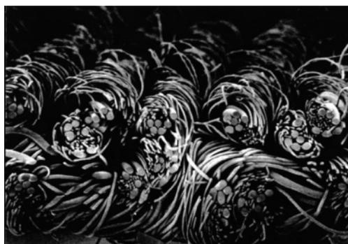
図7.22 複合仮撚加工糸織物断面
