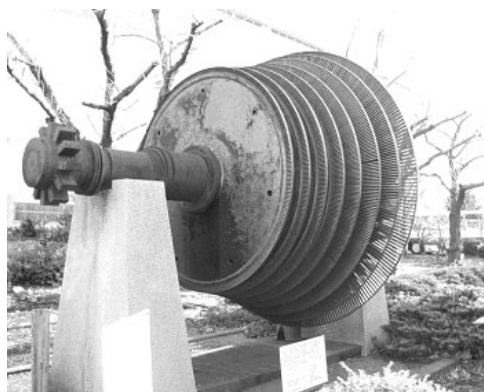
図2.8 八幡製鉄 西田発電所国産25,000kWタービン低压ロータ (株)東芝 京浜事業所所蔵
