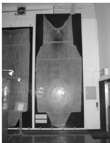
図6.1 75トン鋼塊全断面でのサルファープリント 日本製鋼所 室蘭製作所蔵
