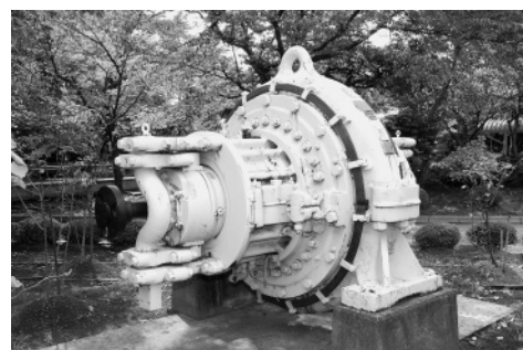
図4.3 アレキサンダーソン高周波発電機 125kVA-3,000min -1 -12,000Hz (株)東芝 京浜事業所蔵
