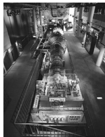
図4.6 日本初の100MVAを超えた160MVAタービン・発電機ロータ 東京電力株式会社「電気の史料館」展示
