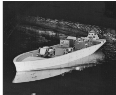
写真3.3.6 水槽試験（日本造船工業会30年史）
