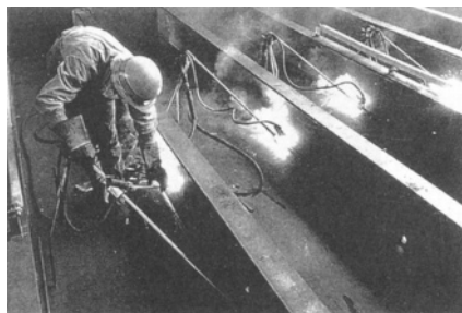
写真3.3.2 グラビティ溶接（造船の溶接—35年の歩み）
