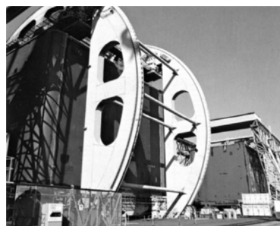
写真4.3.2 ロータスシステム (日本造船工業会30年史)
