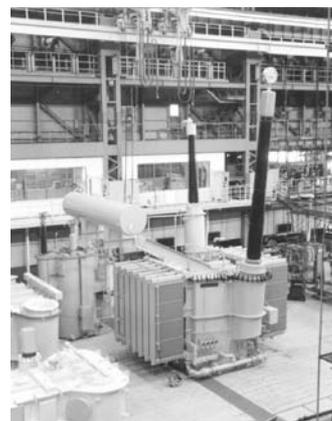
写真5.3 ブラジル向け765/500kV 1650/3MVA (1988年 東芝製)
