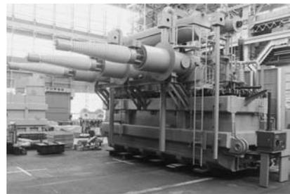
写真5.18 250kV直流送電用変圧器 電源開発函館変換所 (1979年 日立製)
