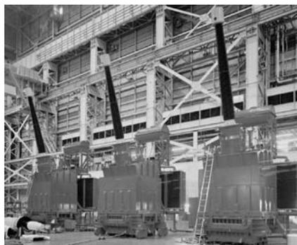
写真5.2 初の765kV変圧器 ベネズエラ向け805/3MVA (1982年 三菱製)
