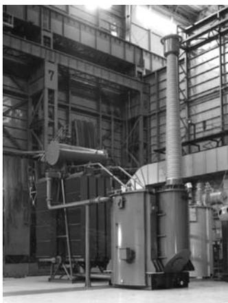
写真5.7 南アフリカ向け765kV 400/3MVA 分路リアクトル (1985年 東芝製)
