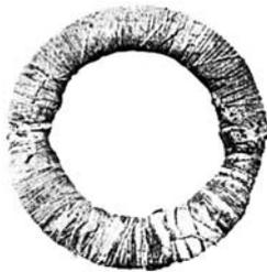
写真3.1 Faradayの電磁誘導線輪モデル (1831)
