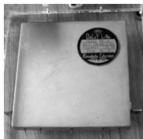
写真1 ETL Mark III 超音波遅延線記憶装置 (産業技術総合研究所にて撮影)
