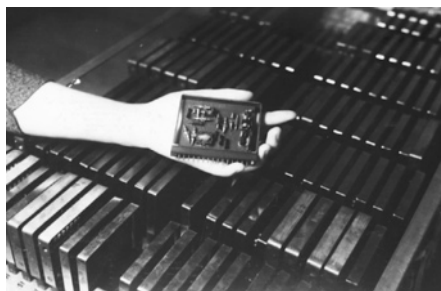
写真2 ETL Mark III プラグインパッケージ (産業技術総合研究所提供)
