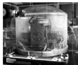
写真5 ETL Mark IV 磁気ドラム (産業技術総合研究所にて撮影)
