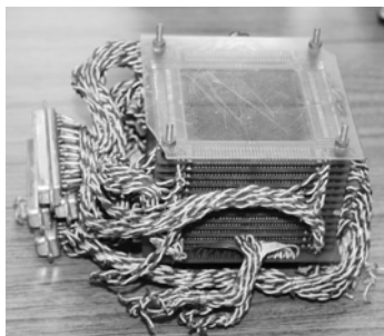
写真7 ETL Mark IVA 磁心記憶 (産業技術総合研究所にて撮影)
