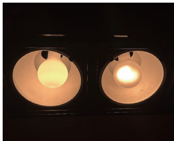
図 5.2 LF 電球（右）と LW 電球（左）の違い
