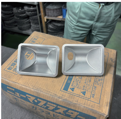
図3(d) 拡散面を持った反射鏡
