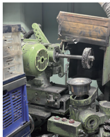
図3(c) バフ研磨での鏡面加工
