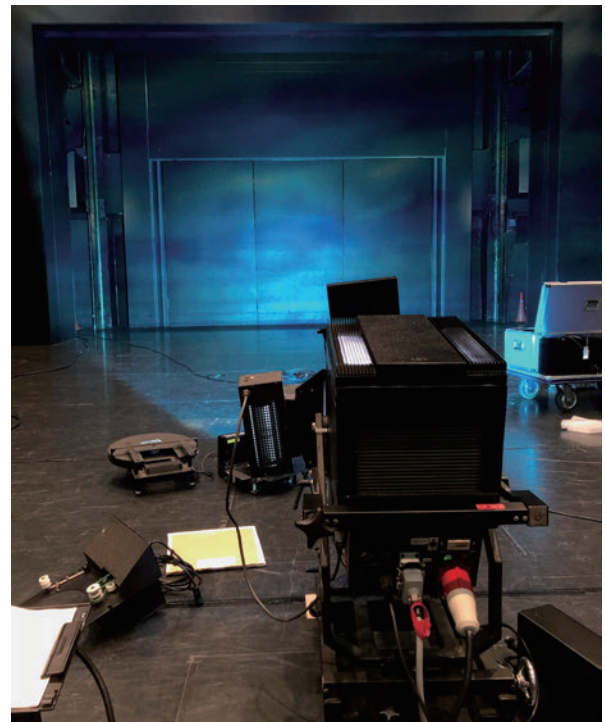
図 4.14 プロジェクタースポットライトによる背景の投影実験
