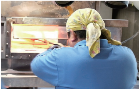
図 4 (b) 約 1,000 °C まで加熱しガラスを円柱状にもみ上げる
