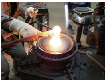
図 4 (a) 連続溶解炉からガラス種を金型に落としはさみで切る
