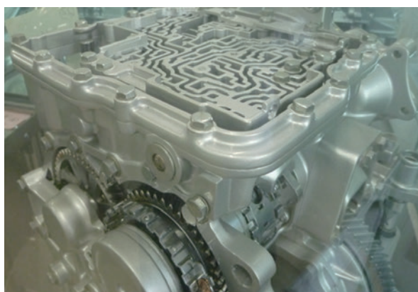
図4 油圧制御部の外観写真（多層バルブボディの上部バルブボディを外した状態） 3)
