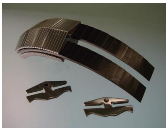
図 2 金属 V ベルトの構成写真 1)
