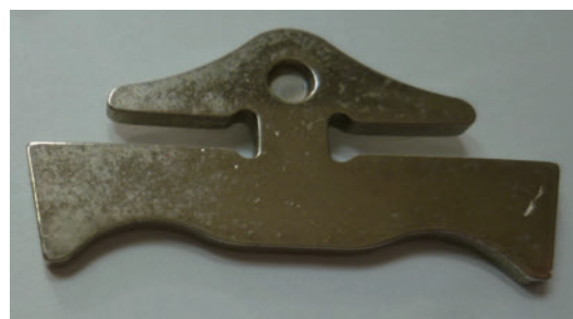
図 4.17 金属 V ベルトのエレメント裏面 (量産品) (筆者撮影, 2003 年)
