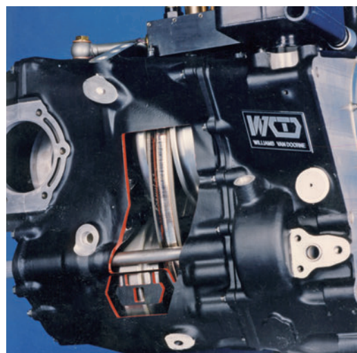
図 2.23 フォーミュラー・ワン (F1 : FW15C) 用の 金属 V ベルト式無段変速機 (開発品) 10)
