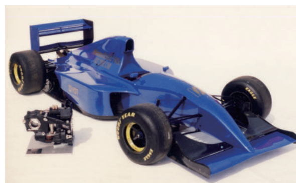
図 2.22 金属 V ベルト式無段変速機と フォーミュラーカー (Williams FW15C) 10)
