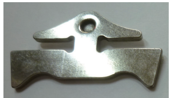
図 4.14 金属 V ベルトのエレメント裏面 (量産品) (筆者撮影, 1988 年)
