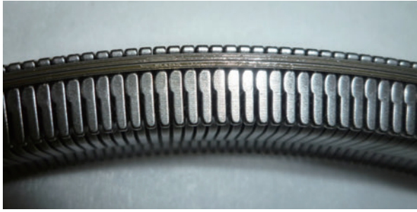
図 4.11 金属 V ベルトの側面 (量産品) (筆者撮影, 1998 年)
