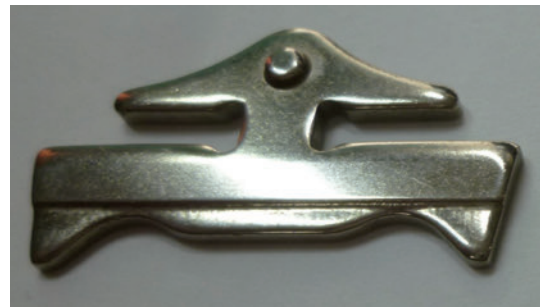
図 4.13 金属 V ベルトのエレメント表面 (量産品) (筆者撮影, 1988 年)
