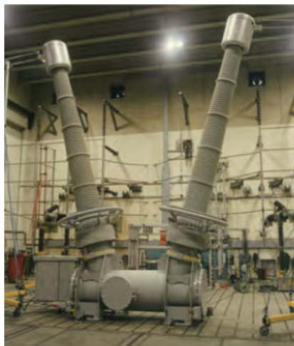
図 2.67 KEMA で形式試験中の日立製作所製 550 kV 一点切タンク形ガス遮断器（1996）（掲載許諾）
