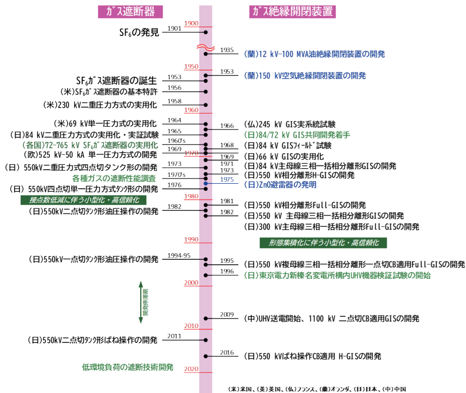
図 5.8 SF 6 ガス遮断器の開発変遷
