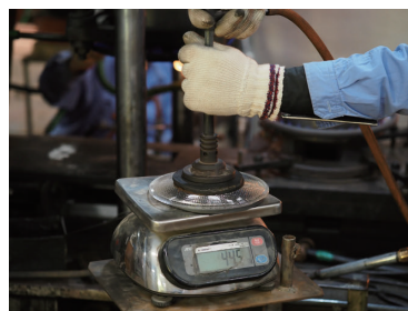
図 4 (d) 形状確認、重量測定
