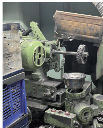
図3(c) バフ研磨での鏡面加工
