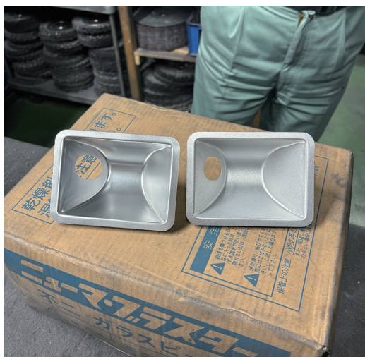
図3(d) 拡散面を持った反射鏡
