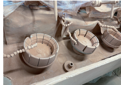
図 4 (e) 研磨機で研磨(徐々に研磨剤を細かくしていく)
