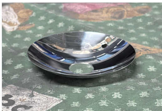
図3(b) バフ研磨後の鏡面反射鏡
