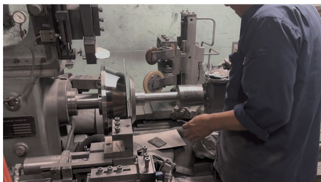
図3(a) 反射鏡絞り加工
