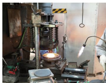
図 4 (b) 切った後をバーナーでなじませプレスへ
