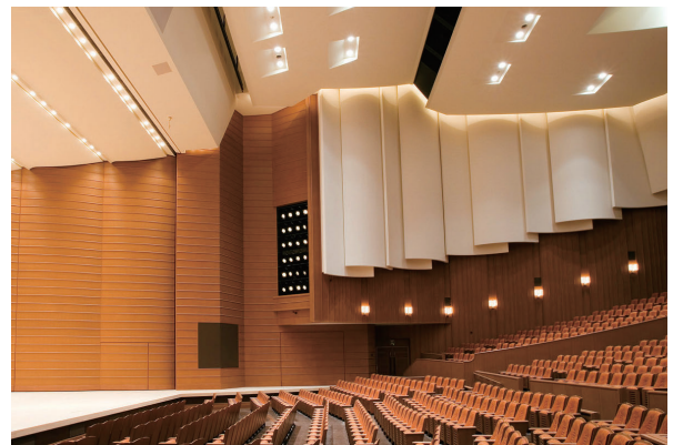
図 3.8 フロントサイドスポットライト （三田市総合文化センター）
