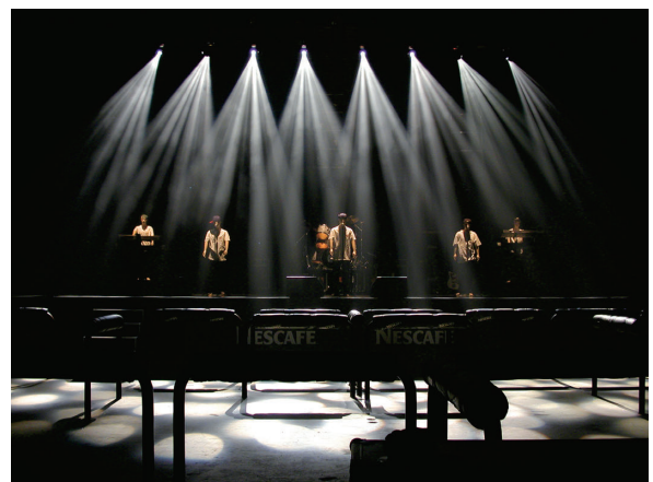
図 4.24 プロファイルスポットライトのゴボの効果
