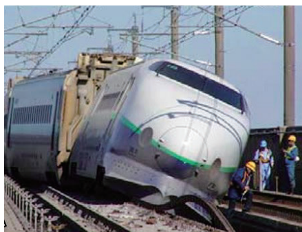
図 5.25 地震により脱線した新幹線 (とき 325 号) 5-40) 「鉄道事故調査報告書 I 東日本旅客鉄道株式会社 上越新幹線浦佐駅～長岡駅間 列車脱線事故」(航空・鉄道事故調査委員会) ( https://jtsb.mlit.go.jp/railway/rep-acc/RA2007-8-1.pdf の P.38 を一部トリミング)
