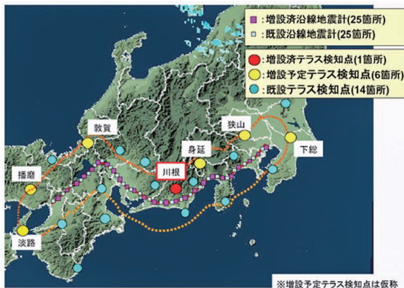
図 5.9 2007年時点の東海道新幹線の地震計の配置 5-17) (掲載許諾)
