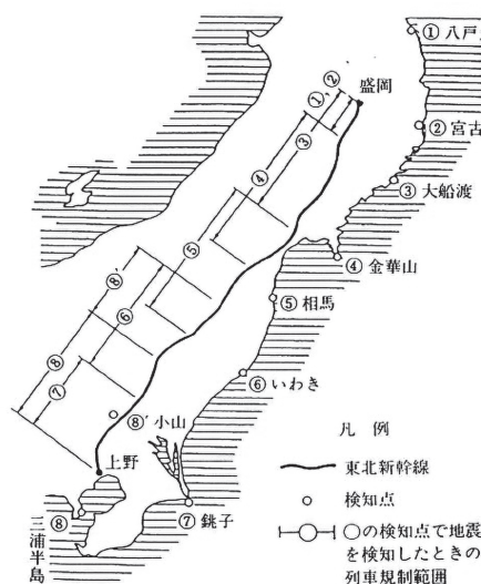
図 5.16 東北新幹線の地震警報システム(1982年時) 5-28) (掲載許諾)
