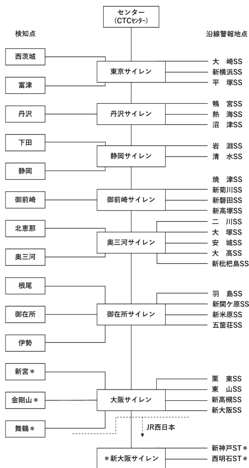
図 4.25 東海道新幹線の地震警報システムのブロック図 (文献 4-2) を基に筆者作成)
